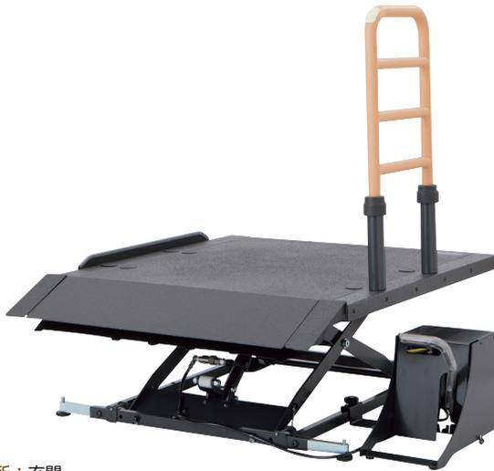
スロープが置けないスペースにも設置できるコンパクトサイズです。電源不要でフットポンプについているペダルを踏むとテーブルが昇降します。
